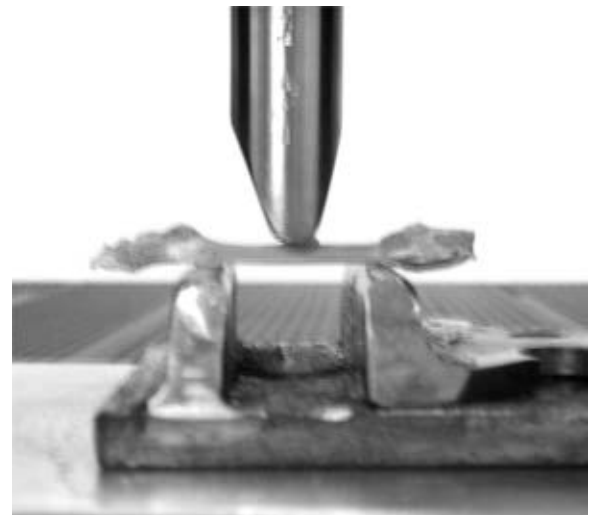
Figura 2 - Ensaio mecânico de flexão, em três pontos, no corpo de prova fêmur de rato.
